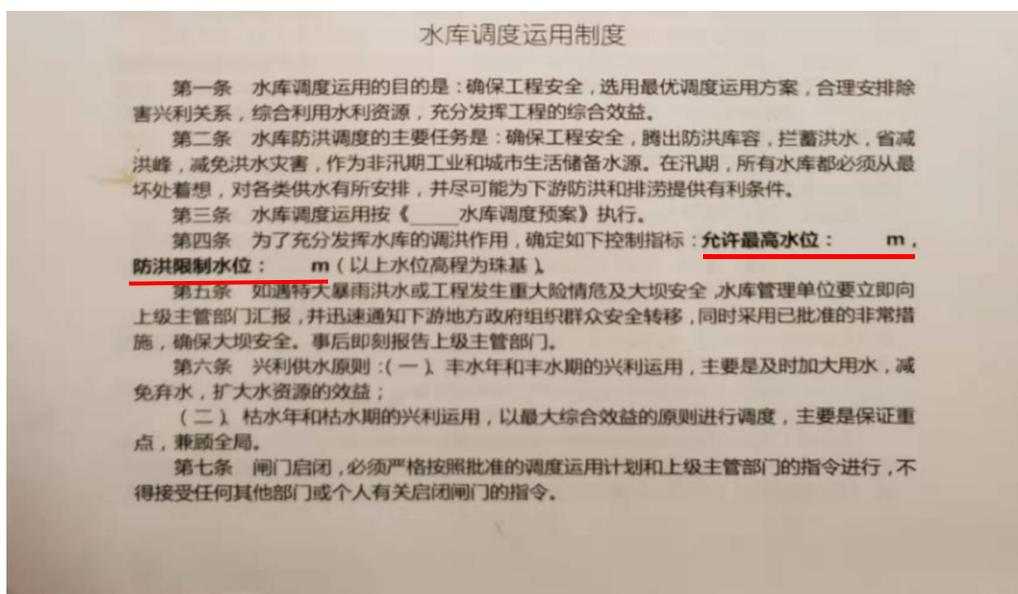
调度运用方案未明确“允许最高水位”“防洪限制水位”
